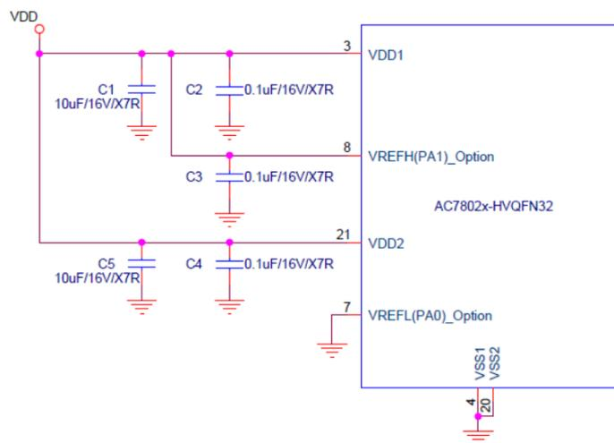
图 2-1 电源电路参考设计 (HVQFN32)
