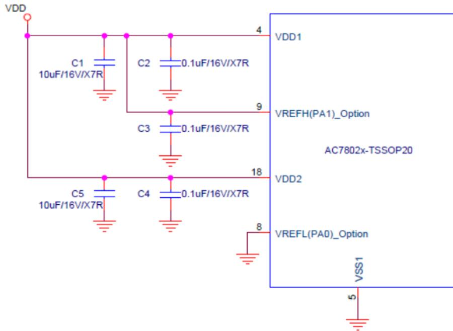
图 2-2 电源电路参考设计 (TSSOP20)
