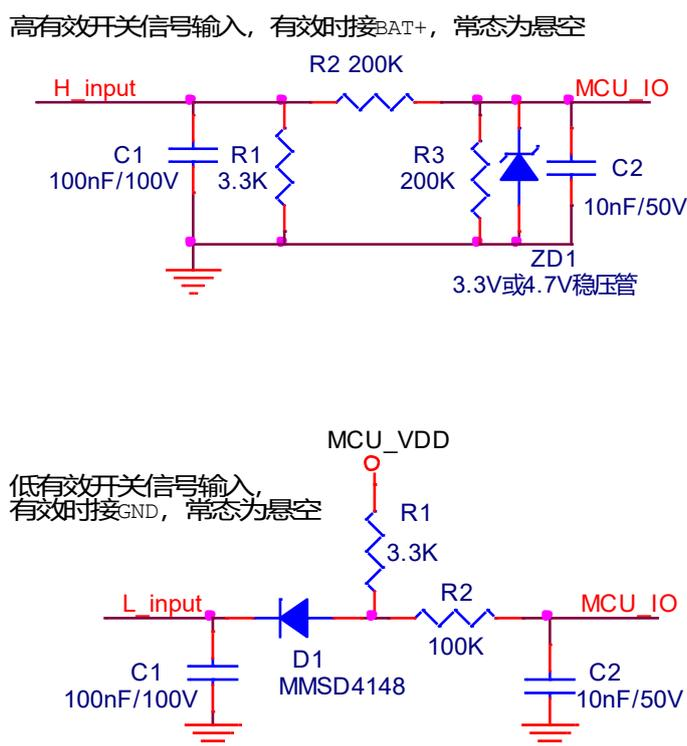
图 8-1 GPIO 输入电路设计参考电路
