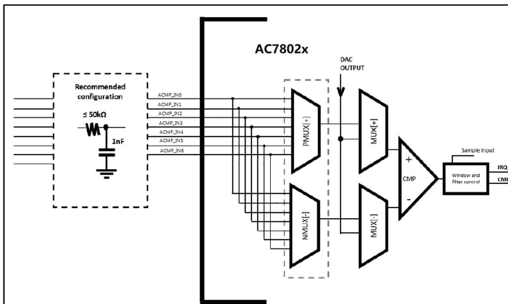
图 7-1 ACMP 电路设计示意图
