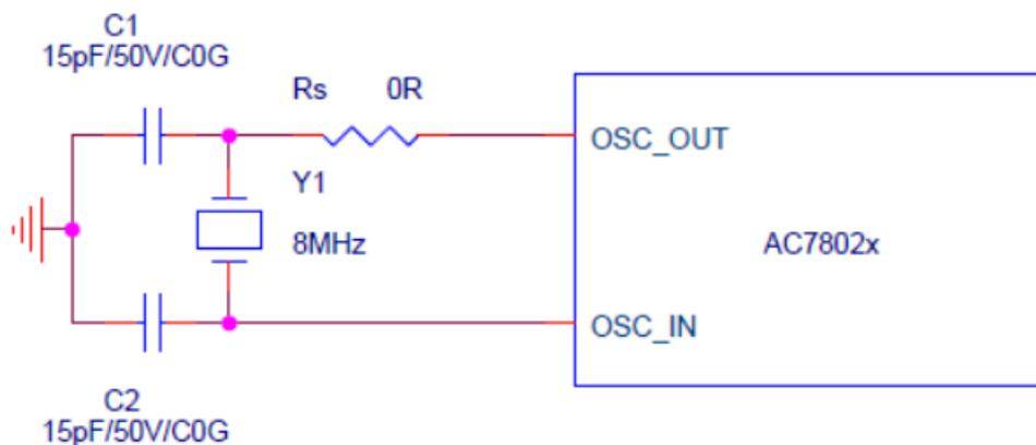
图 3-1 晶振参考电路
