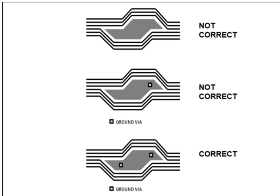
图 11-4 消除浮动金属形状
