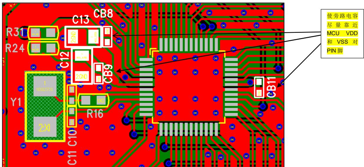
图 11-1 旁路电容 PCB 参考设计
