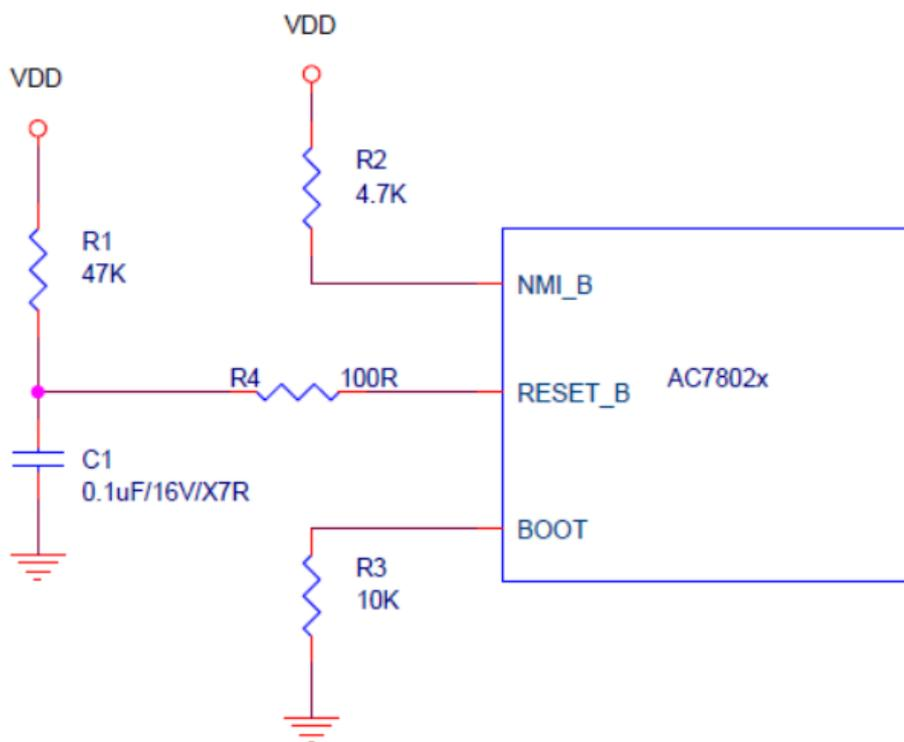
图 4-1 复位电路、NMI 及 BOOT 引脚参考电路
