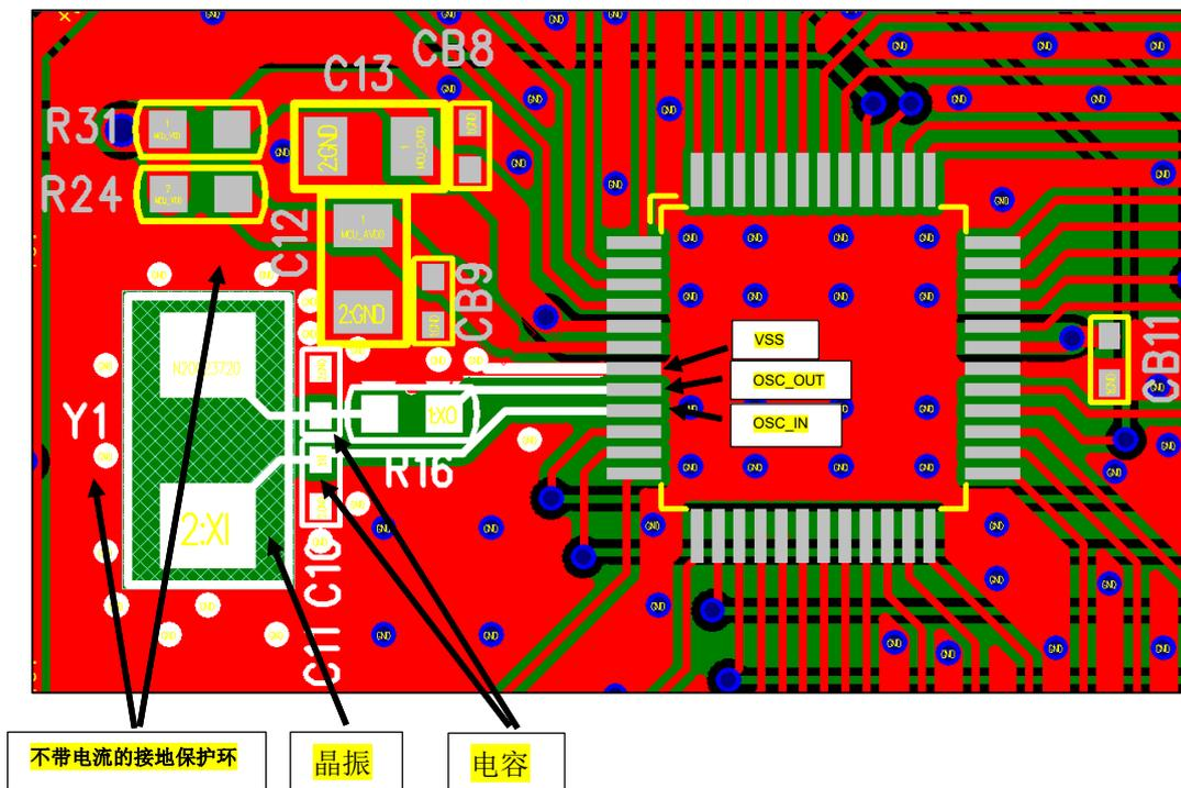
图 11-2 外部晶振 PCB 参考设计
